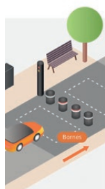
Détail de l'emplacement des bornes escamotables installées pour réguler la circulation
